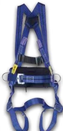
Imbracatura TITAN a 2 punti di attacco, dorsale e sternale. Nastro tessile in poliammide 45mm blu con riga a contrasto nera sulla parte esterna. Cintura di posizionamento, anelli laterali e fibbie ad apertura rapida in acciaio inossidabile; cosciali regolabili. Peso: 1 kg.
