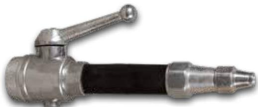
Lancia antincendio a getto conforme alla norma UNI EN 671-2. Interamente costruita in lega di alluminio leggera con guarnizioni in gomma. Funziona mediante valvola a sfera e tramite un dispositivo che produce un largo getto di acqua frazionata. La leva di comando permette il passaggio da chiuso a getto pieno o frazionato. In posizione di getto pieno è garantito un passaggio d'acqua omogeneo.
