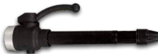
Lancia antincendio a getto conforme alla norma UNI EN 671-2. Composta da corpo in alluminio rivestito, guarnizioni in gomma, canna in resina ABS antiurto con scanalature di presa antiscivolo ed ugello in polimero rinforzato. Funziona mediante valvola a sfera e tramite un dispositivo produce un largo getto di acqua frazionata. La leva di comando permette il passaggio da chiuso a getto pieno o frazionato. In posizione di getto pieno è garantito un passaggio d'acqua omogeneo.
