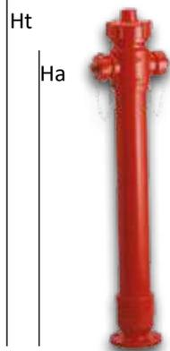
Dotato di scarico automatico antigelo; sbocchi filettati maschio UNI 810 in ottone EN 1982 e con tappi in ottone EN 1982. Attacco flangiato forato PN 16. Verniciatura in rosso RAL 3000
