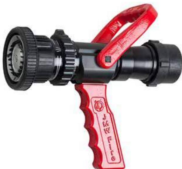
Lancia Spray Jet 2" Uso professionale- getto pieno-spray-velo di protezione Angolo di erogazione del getto (30° -120° ) per l'ottimizzazione dell'effetto di spegnimento. Portata 100/300 L/min
