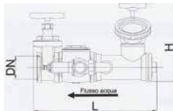
GRUPPO ATTACCO MOTOPOMPA DI MANDATA UNI 10779 FILETTATO CON ATTACCHI UNI70 - UNI804 REALIZZATI IN OTTONE EN 1982
